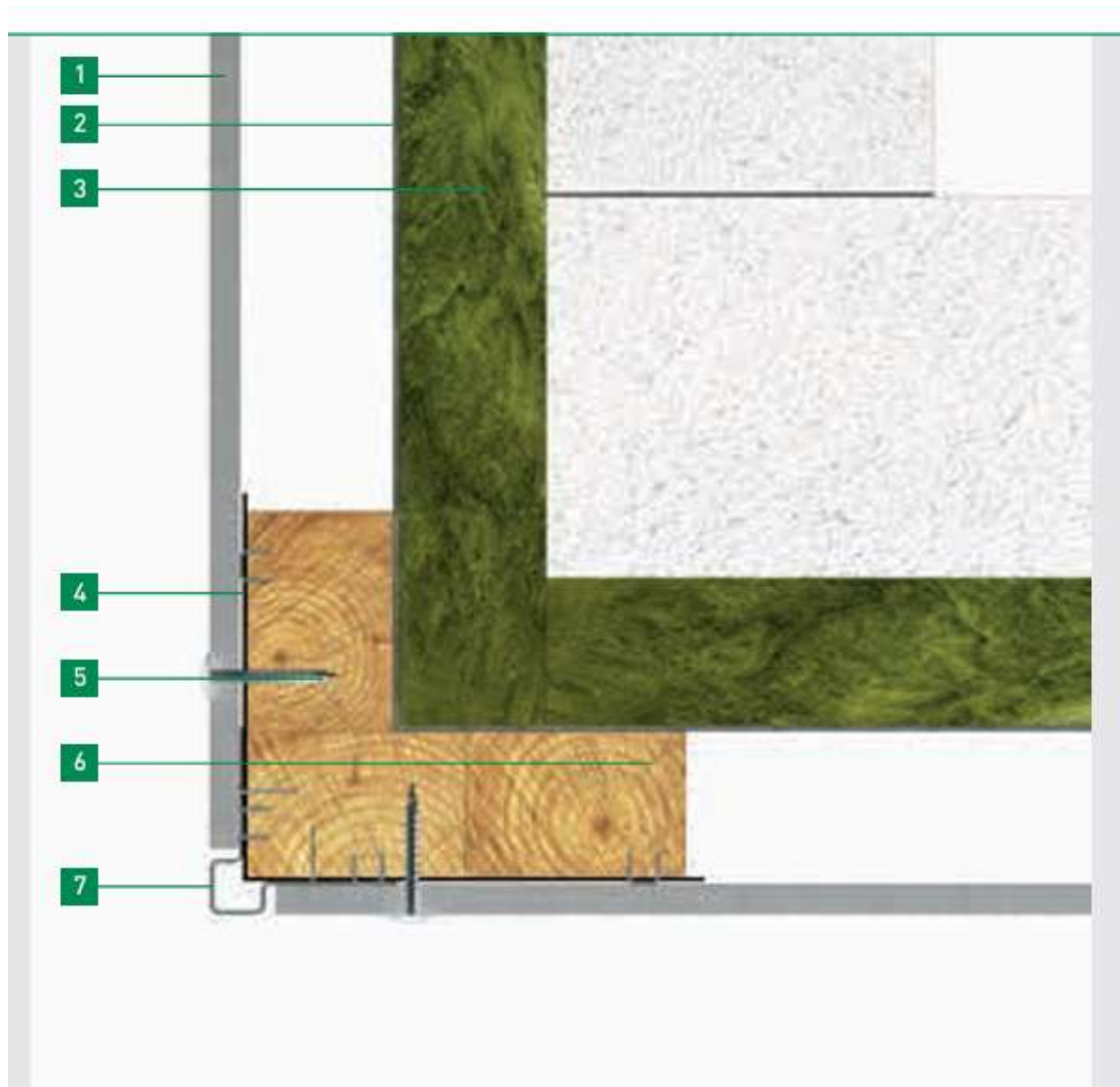
PILT 4. Tuulduva välisseinatarindi 90 kraadise nurgaliide nurgaliistuga (põhimõtteline skeem).
