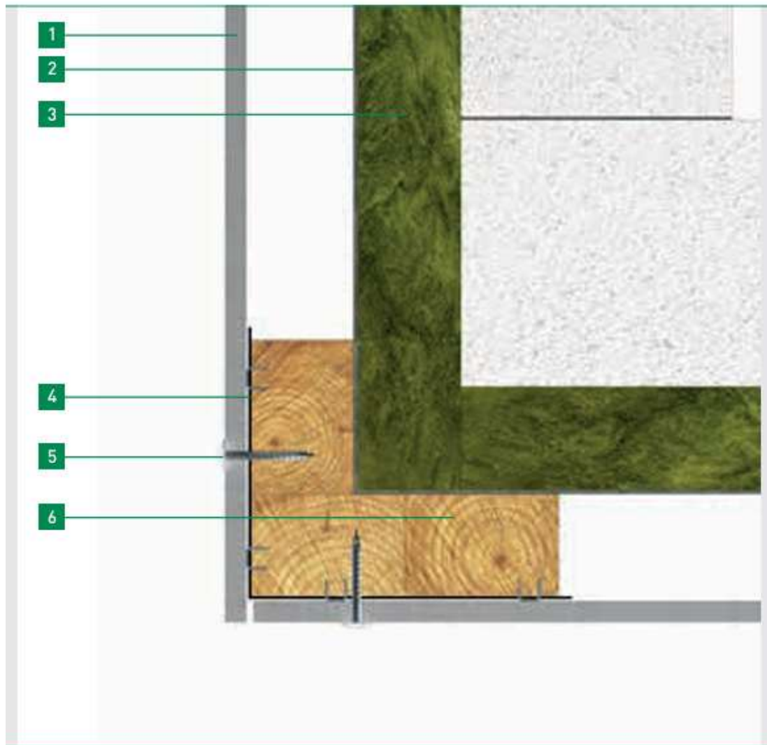
PILT 5. Tuulduva välisseinatarindi nurga liide ilma nurgaliistuta (põhimõtteline skeem). Saab kasutada erinevates nurgalahendustes, kus seinanurk ei ole 90 kraadi.
